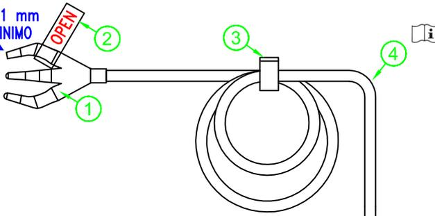
Avvolgere il tubo con la chela in modo circolare e chiuderlo con il gancetto (part. 3) e appoggiarlo sopra il sacchetto in PE (part. 18)
