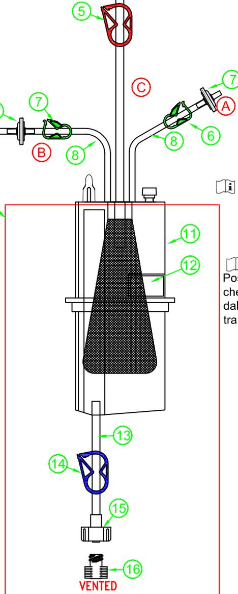
Fissare il sacchetto in PE (part. 18) sull'estremità superiore del Barilotto con nastro virale (fare asola) avendo cura di lasciare sporgenti i 3 tubi
